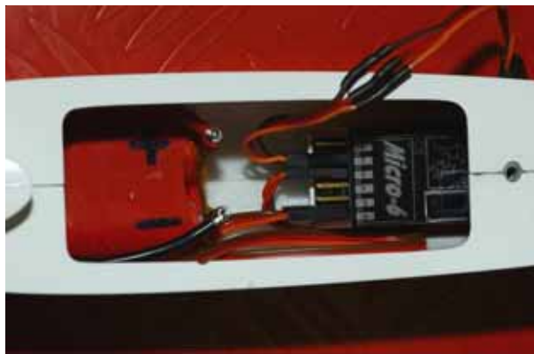
Fertiger Rumpf komplett mit Akku, Empfänger und Servo bestückt. Das heraushängende Kabel ist das Verlängerungskabel für das Querruderservo.
