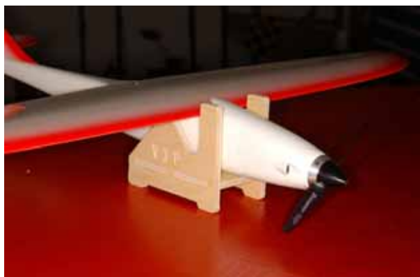
So wird der V.I.P. ausgewogen
