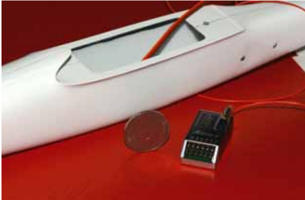
Hier der ACT micro6 Empfänger vor und nach dem Einbau. Dieser wird mit doppelseitig klebendem Klebeband auf den Rumpfboden geklebt.
