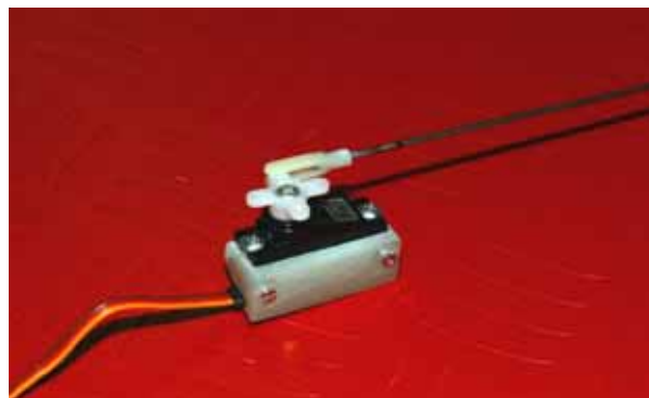
Höhenruderservo (Graupner JR DS281) mit geändertem Gestänge (neuer, breiter Gabelkopf)
