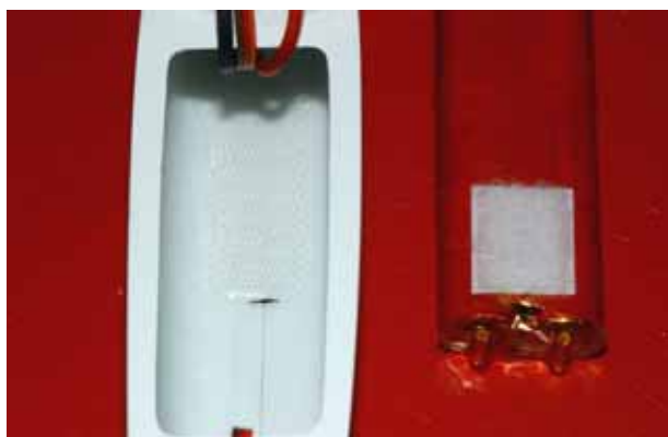
Befestigung des Akkus mit Klettband
