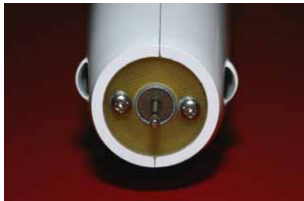
Sicherung der Motorschrauben mit Federringen M2,5 (hier: Speed 400)
