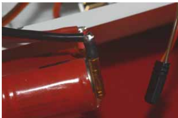
Fertig verlötete Anschluss-Stecker von der Seite betrachtet
