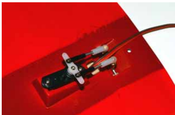
Servo Befestigung in der Tragfläche (MS-X3). Die Hebelarme können noch mit einer Zange abgezwickt werden.
