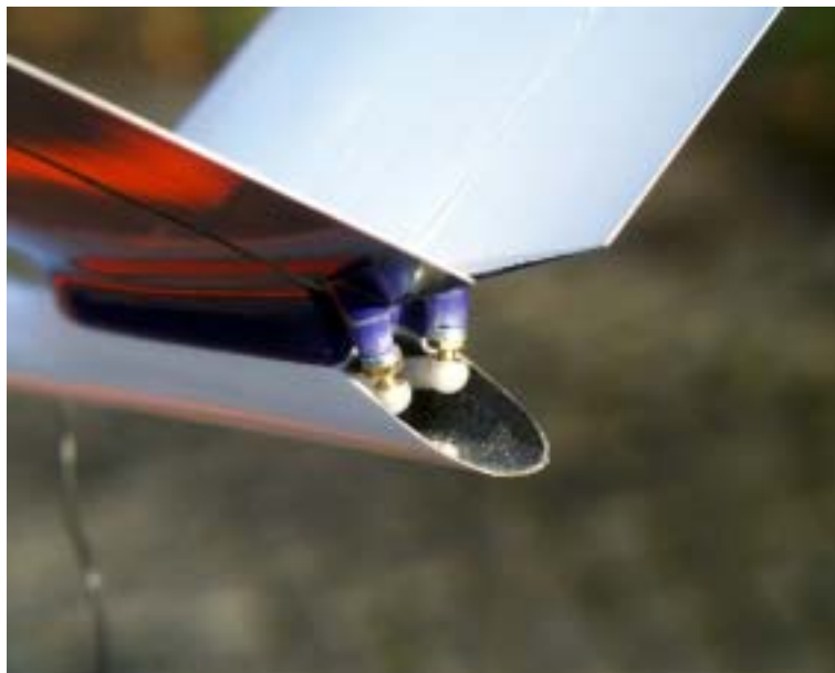
Alle Ruderanlenkungen mit Kugelanschlüssen fertig montiert
