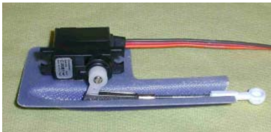
Bild 1 und 2 zeigen die Platzierung des Querruderservo mit Anlenkung auf der GFK-Abdeckung, sowie die Neutrallage des Servohebels in Richtung Nasenleiste.
