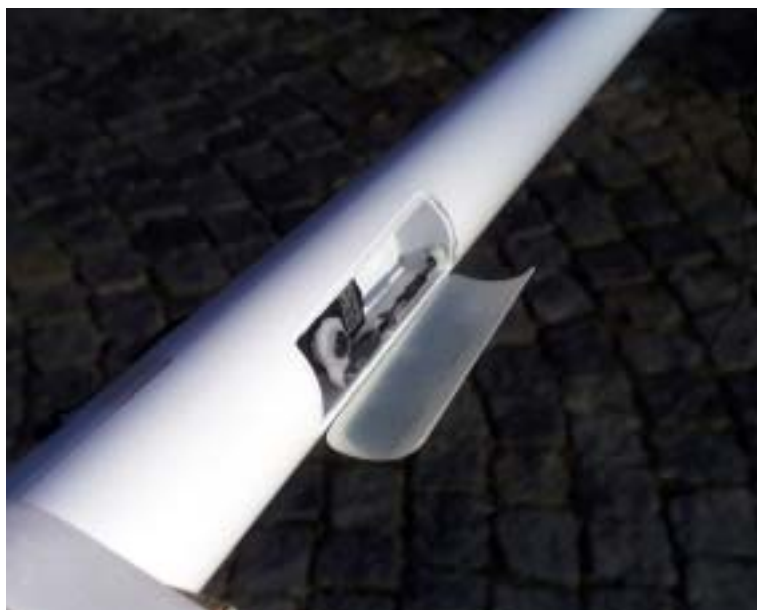
Höhenruderservo von aussen montierbar
